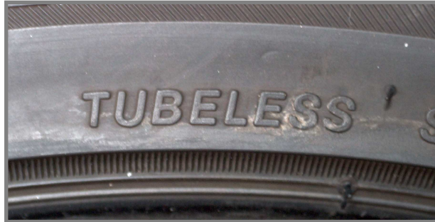
3. ábra. Belső tömlő nélkül használható gumiabroncs jelölése.
