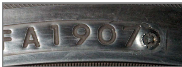
5. ábra. Gyártási dátum jelölése a gumiabroncsokon.
